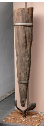
Unterer Rest eines hölzernen Brückenpfahls. Damit die Spitze beim Einrammen in den Untergrund nicht abbrach, wurde sie mit einem eisernen Pfahlschuh ummantelt.
